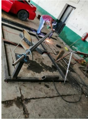
Figura 54. Fijación de flecha mediante soldadura.
