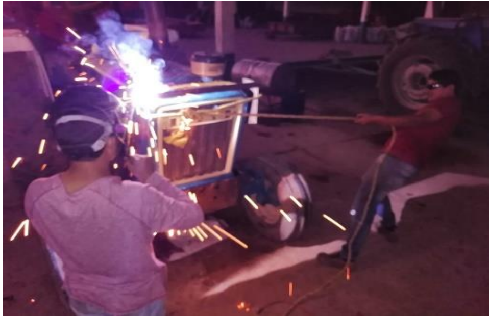
Figura 57. Proceso de soldadura a base del tractor.
